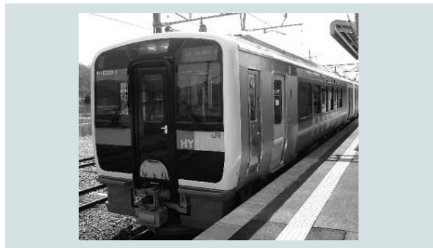
図5 JR東日本「キハE200形」ハイブリッド車両の外観 小海線で2007年7月から営業運転を開始している。
