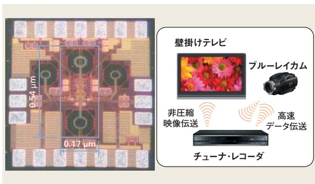
6 試作した発振器のチップ(左)とミリ波無線伝送システムの応用例(右)
