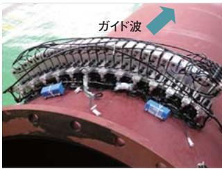
**図10 部分設置型ガイド波センサー**
