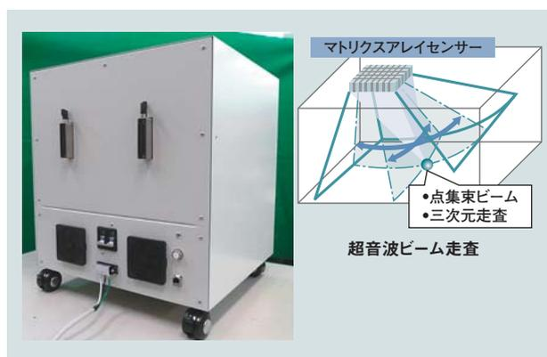
図4 3D Focus-UTシステム
