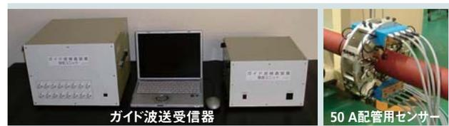
図9 ポータブルガイド波検査システム
