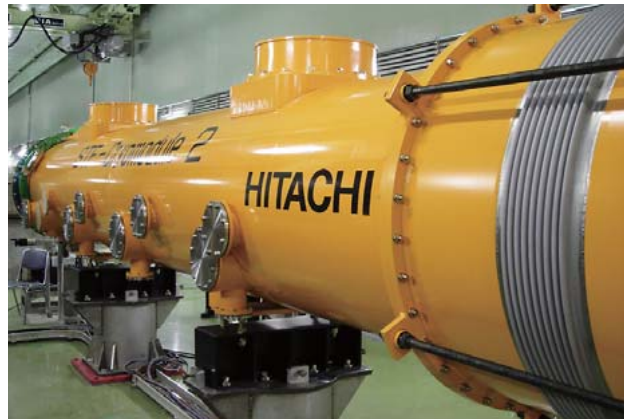
図6 先端加速器用超伝導空洞用クライオスタット 将来の高エネルギー加速器に向けた機器開発に取り組んでいる(写真提供:大学共同利用機関法人高エネルギー加速器研究機構)。
