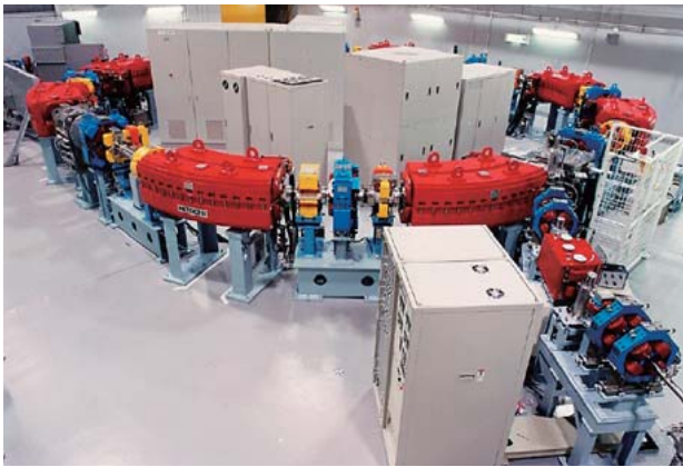
図5 多目的シンクロトロン・タンデム加速器システム イオンビームを材料科学、生物、医療研究などに幅広く活用している(写真提供:財団法人若狭湾エネルギー研究センター(福井県))。
