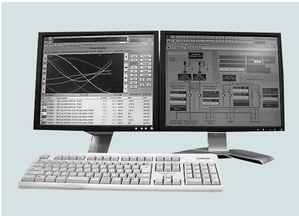
図5 マルチモニター 1) 複数画面を同時に開くことにより、きめ細かい監視・運転が可能である。
