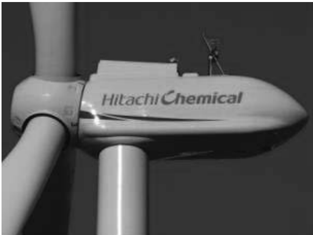
図4 量産機のナセル部 軽量化に配慮するとともに、ダウンウィンド風車としての風向を考慮した流線型としている。この写真において風は、右から左に向かっている。
