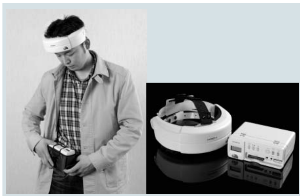
図5 携帯型光トポグラフィ技術 重量1 kg (計測部400 g) の携帯型光トポグラフィ技術を試験的に開発した。
