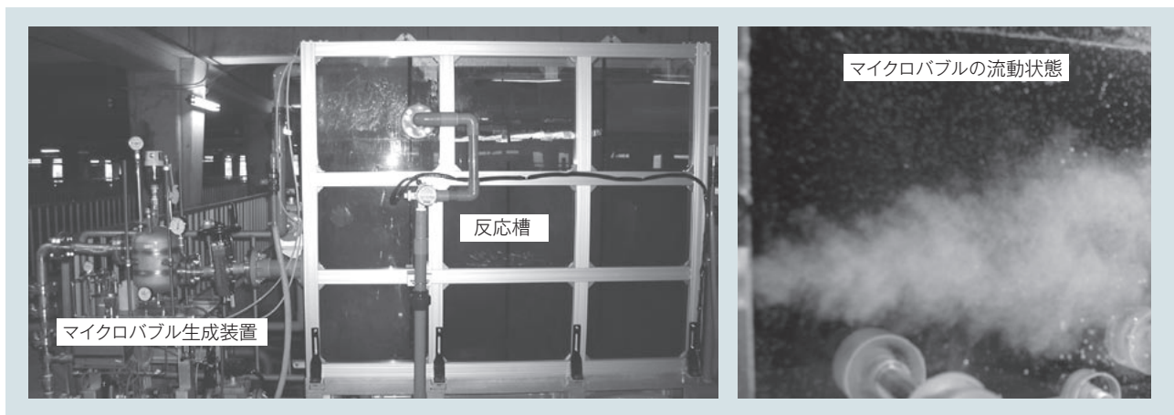
図4 マイクロバブルの流動状態と実証設備 下水処理場での実証実験により、マイクロバブルの処理性能を確認し、製品化した。
