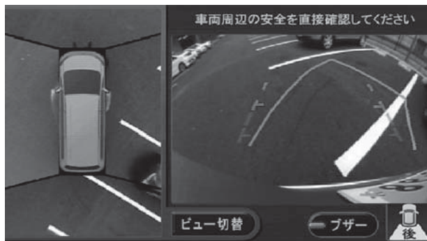
図4 アラウンドビューモニタ表示例
