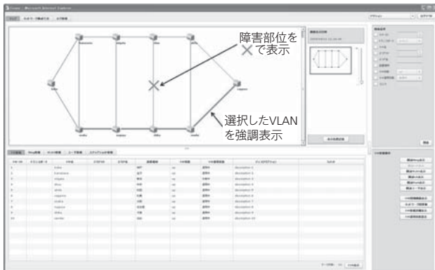
図2 論理ネットワークオペレーティングシステムのマップ画面 画面上部のマップ画面においては選択したVLANを強調表示させたり、障害部位を表示させたりすることができる。
