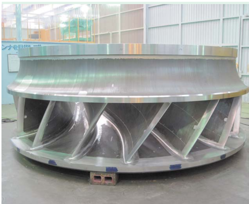
4 工場製作中の更新用ランナ（前進翼ランナ、天地状態）
