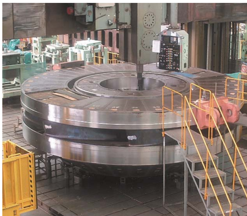
3 製作中の関西電力株式会社奥多々良木発電所中間羽根付きポンプ水車ランナ
