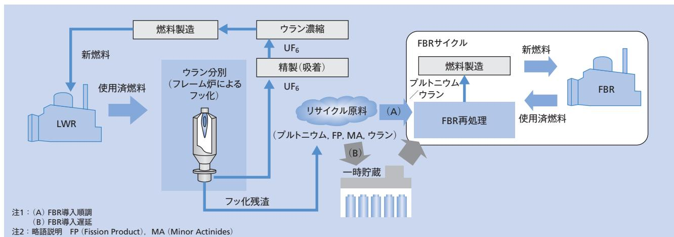
図5 フッ化法を適用したFFCIのプロセスフロー
