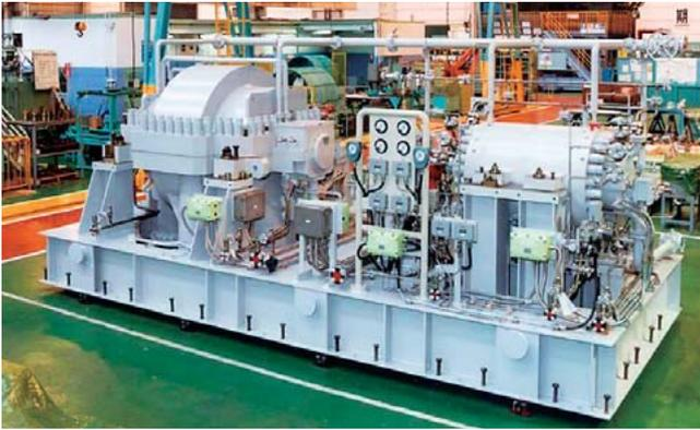
図7 | CO<sub>2</sub>液化用遠心圧縮機
