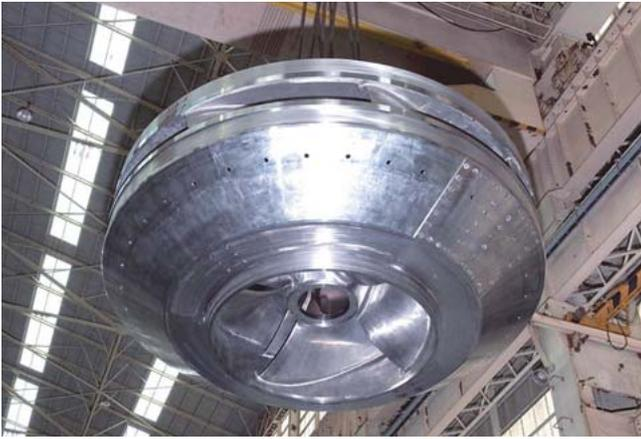
図7 | 製作中の関西電力奥多々良木発電所中間羽根付きポンプ水車ランナ可変速化のために新設計した。羽根長さが長い主羽根と短い中間羽根を交互に配置した中間羽根付きランナで、効率改善と安定運転範囲拡大を実現した。
