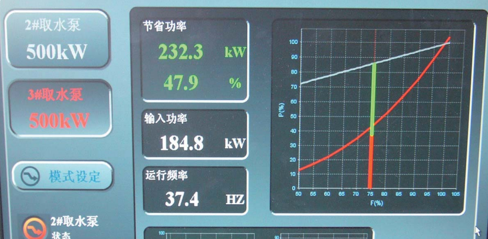
雲南省でインバータ設備とともに導入した省エネルギーリアルタイムモニタリング技術「省エネ見える化」。中国の製造業における業務改善に貢献している。
