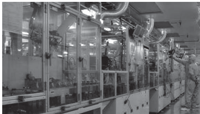
図9 | 量産ライン (セル組立ライン: 日立ピークルエナジー東海事業所内) 月産30万セルの組立ラインが完成し, 2011年から量産を開始する。
