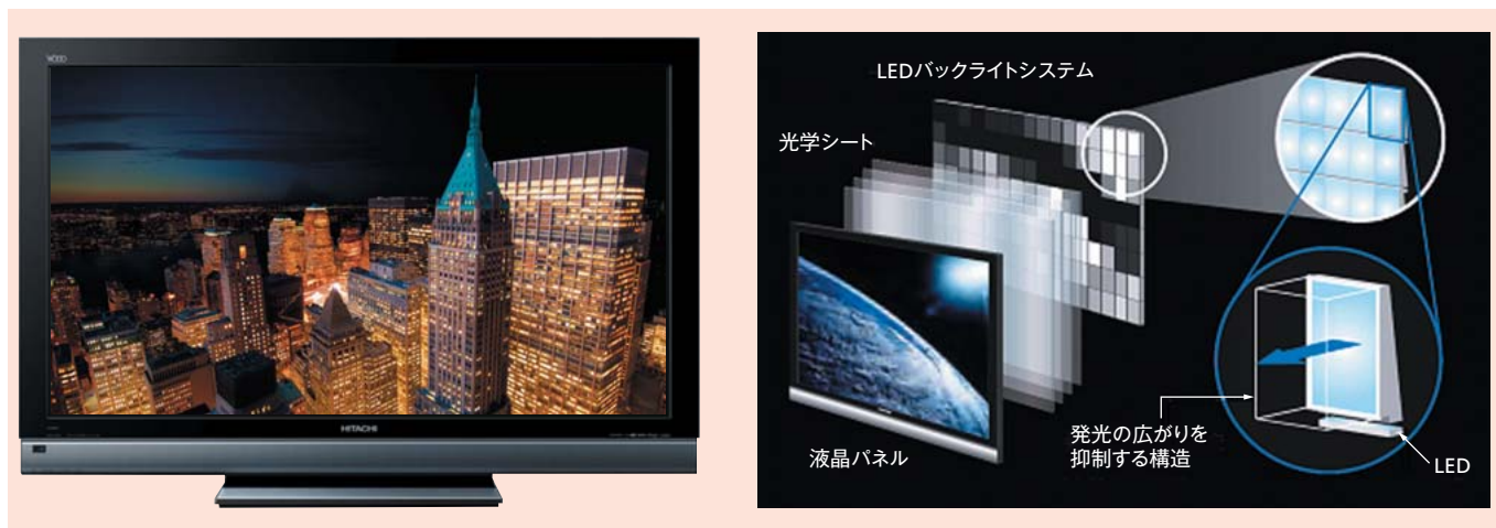
2 スリムブロック型LEDバックライト搭載液晶テレビ (L42-ZP05) の外観(左、画面ははめ込み)とスリムブロック型LEDバックライトの原理(右)
