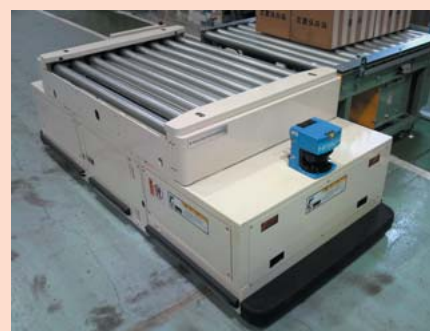
11 自律走行型無人搬送車「インテリジェントキャリア」の搬送重量100 kgタイプ (左) と500 kgタイプ (右)
