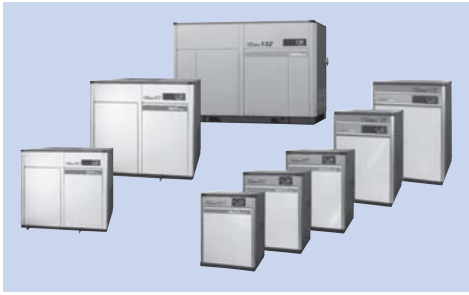
図6 | 給油式スクリーワー圧縮機「NEXTシリーズ」の外観 22～75 kWの変速制御機では、DCBL永久磁石モータを搭載し、高効率化を図っている。ユニットトータルの省エネルギー性にも優れている。
