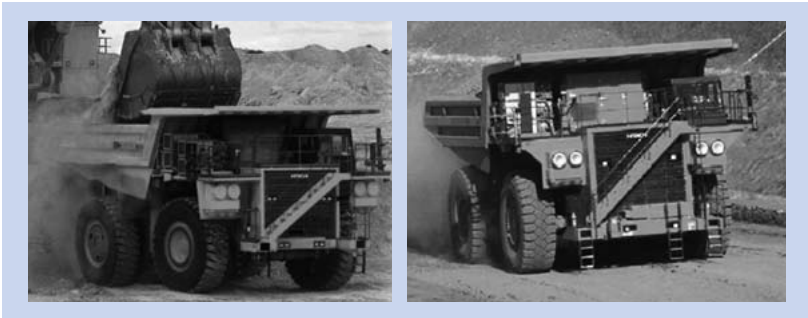
図9 | EH3500ACIIとEH4000ACIIの外観 日立建機株式会社と日立製作所が共同開発したAC-IGBT電気駆動装置を搭載した。
