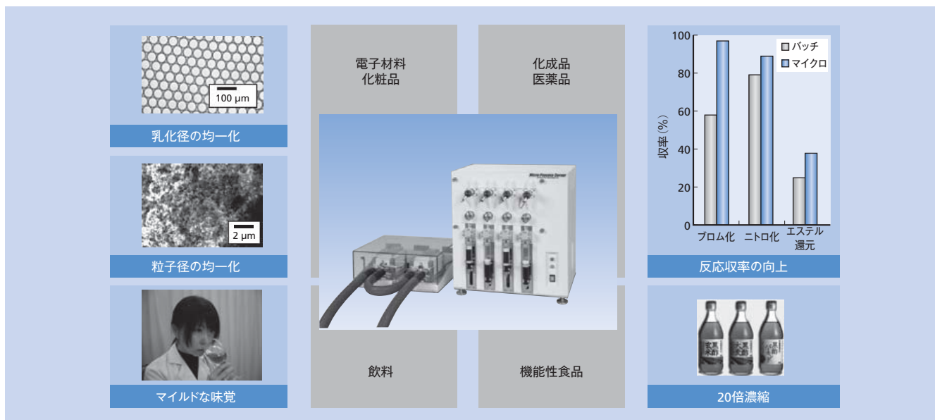
図6 | ラボ用マイクロリアクタと、マイクロリアクタを適用可能なプロセスと適用効果
