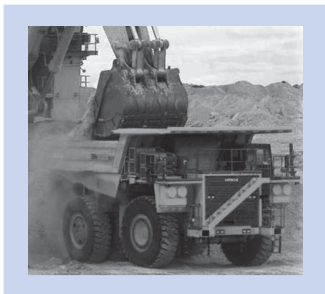
図4 | EH3500ACⅡの外観 IGBT式AC電気駆動装置を搭載した積載量190 t級のダンプトラックである。
