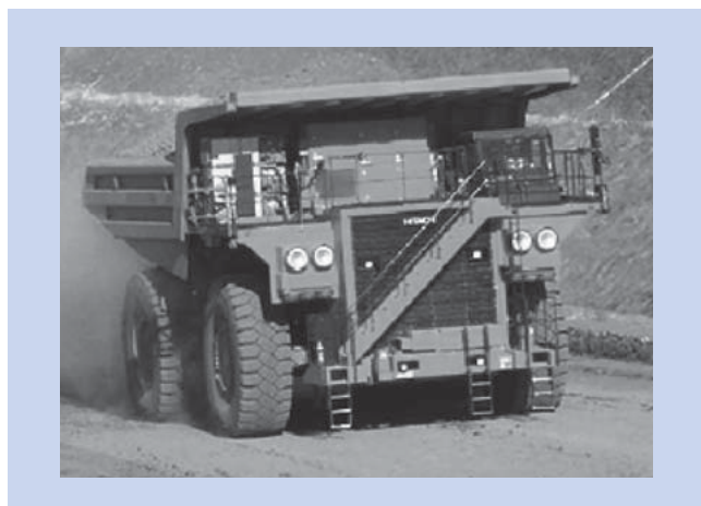
図5 | EH4000ACⅡの外観 2010年11月に発売したシリーズ機、積載量220 t級ダンプトラックEH4000ACⅡの外観を示す。
