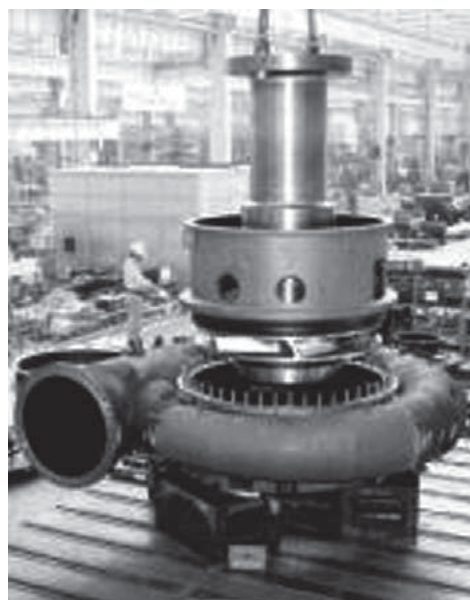
図3 | 米国セントラルアリゾナプロジェクト揚水ポンプ(立軸片吸込みタービン渦巻きポンプ)
