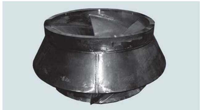
図10 | 溶接構造クローズ羽根車の外観(外径 約φ1,420 mm)
