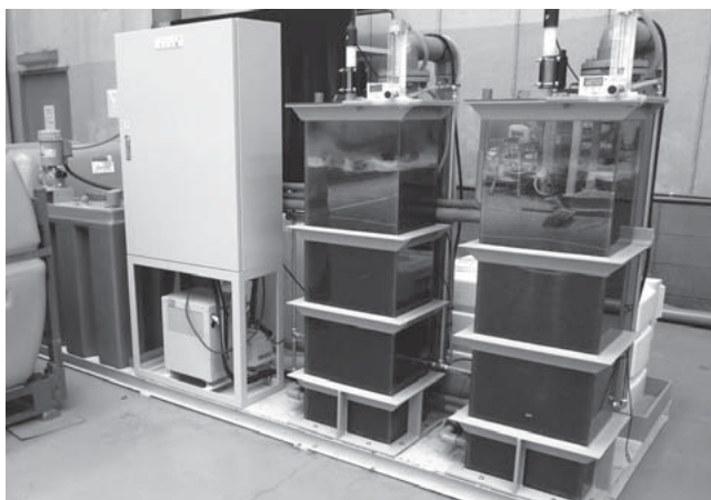
図8 | ジオキサン排水処理実証試験装置
