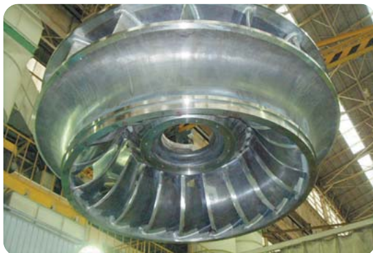
3 インドネシア・タンガ発電所 81.1 MWフランス水車ランナ
