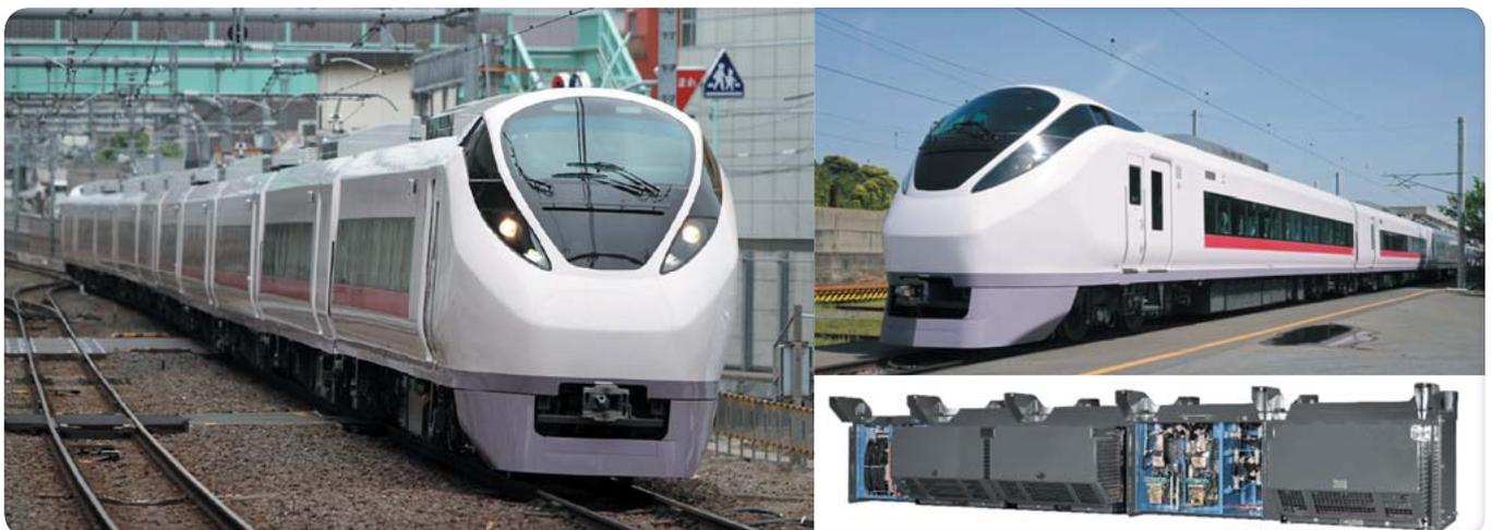
1 東日本旅客鉄道 E657系特急形交直流電車の走行風景（左）、笠戸事業所出場前の様子（右上）、主変換装置（右下）
