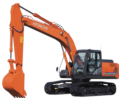
1 ZH200ハイブリッド油圧ショベル（運転質量：20,100 kg）
