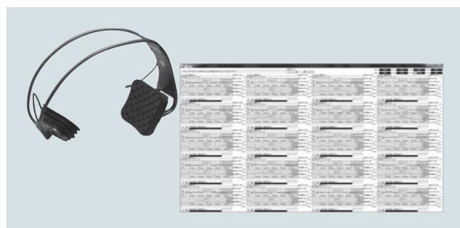
図1 | 超小型試作機の外観(左)と、リアルタイムに計測結果を表示する計測画面(右)
