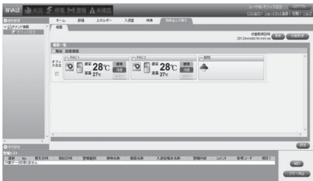
図3 | 簡単な省エネルギー制御画面の例 テナントは専有部の機器をアイコン表示画面から制御可能である。
