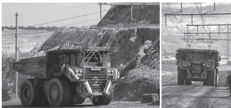
図7 | 日立グループの技術を生かしたトロリー式ダンプトラック
