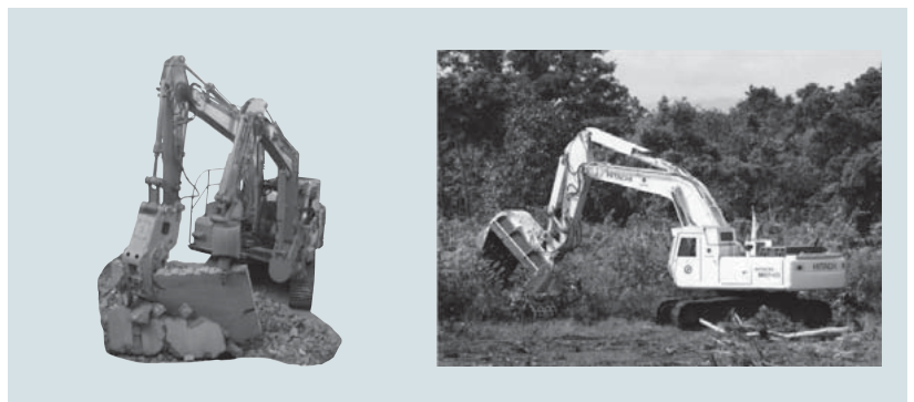
図9 | 双腕作業機 (左) と対人地雷除去機 (右)
