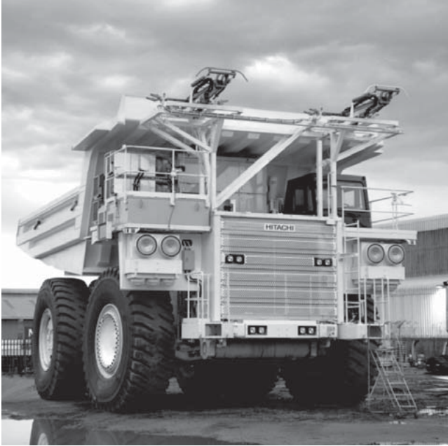
図9 | トロリー式ダンプトラック「EH3500ACII」の外観
