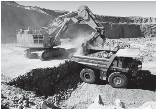
図5 | 稼働中の「EX5500-6」と「EH4000ACII」 オーストラリア東部の石炭鉱山で稼働するEX5500-6とEH4000ACIIを示す。
