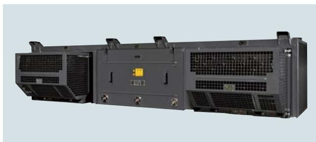
図2 | E233系3000番代増備車用インバータ装置の外観
