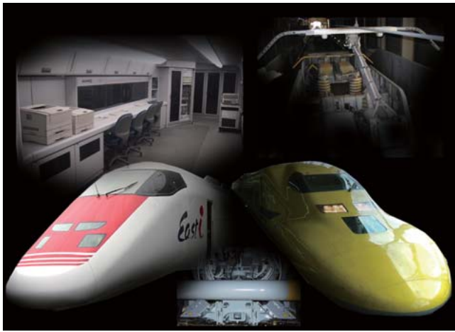
図6 | 新幹線向け総合検測車 東海道・山陽新幹線で検測するドクターイエロー(右)と、東日本旅客鉄道株式会社新幹線管内で検測するEast i(左)に検測装置を搭載している。
