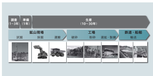
図4 | マイニングの工程 フィールドから輸送までのマイニングの工程全般を示す。
