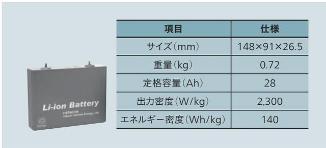
図11 | PHEV/EV用リチウムイオン電池の外観と仕様
