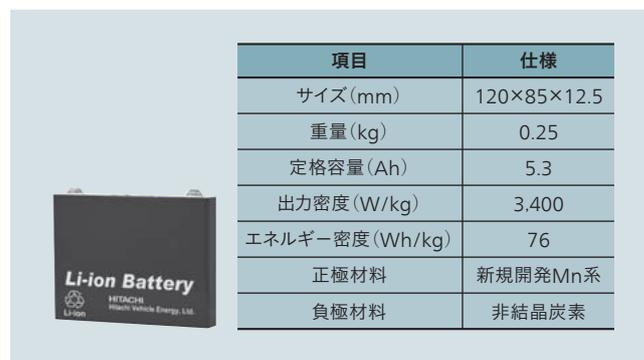
図8 | HEV向け角形リチウムイオン電池の外観と仕様
