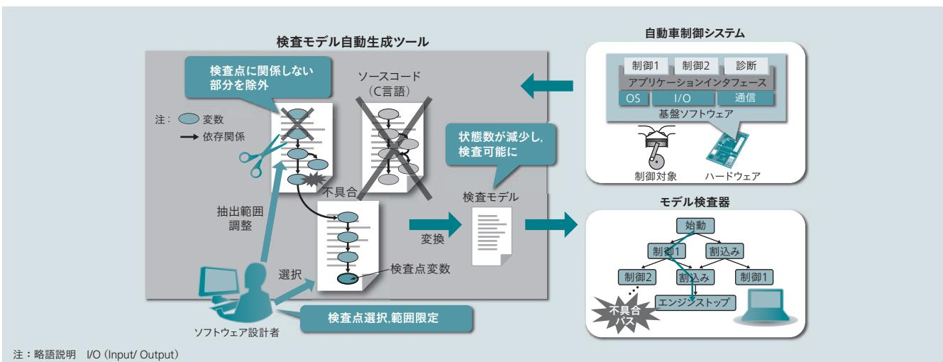
図3 | ソースコードからの検査モデル自動生成技術
