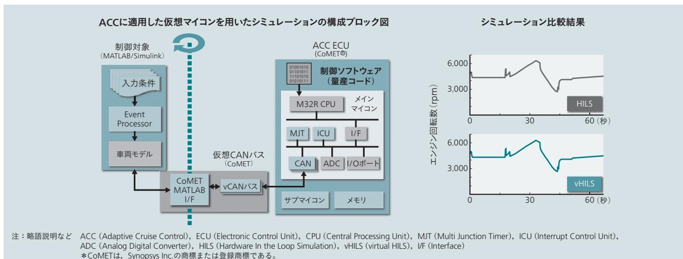
図4 | 仮想マイコンを用いたシミュレーションのACCシステムへの適用
