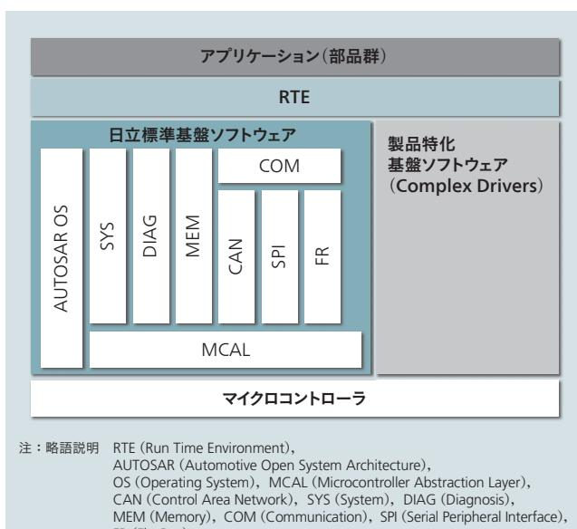
図2 | 日立標準基盤ソフトウェアの概略構成
