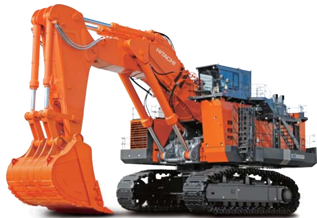
1 マイニング用超大型油圧ショベルEX8000-6バックホウ仕様
