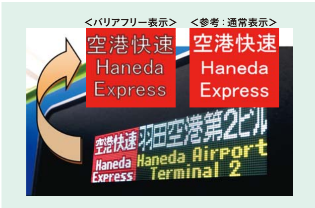
図6 | 側面行先表示器外観および運用種別表示部詳細 「空港快速」および「Haneda Express」の文字周囲にコントラスト調整を施している。
