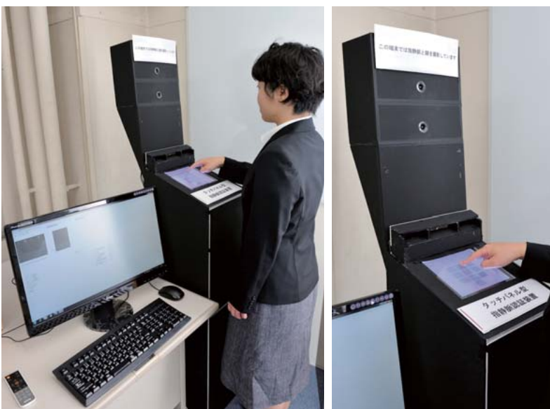
タッチパネル型指静脈認証装置の試作機。タッチパネルを操作している間に指静脈の認証と顔画像の撮影を同時に行うことで、アンコンシャス認証（事前同意を得たユーザー向けの無意識の認証）を実現し、利便性を向上させる。
