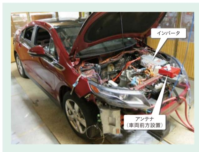
図5 | 電磁ノイズ測定専用車両
