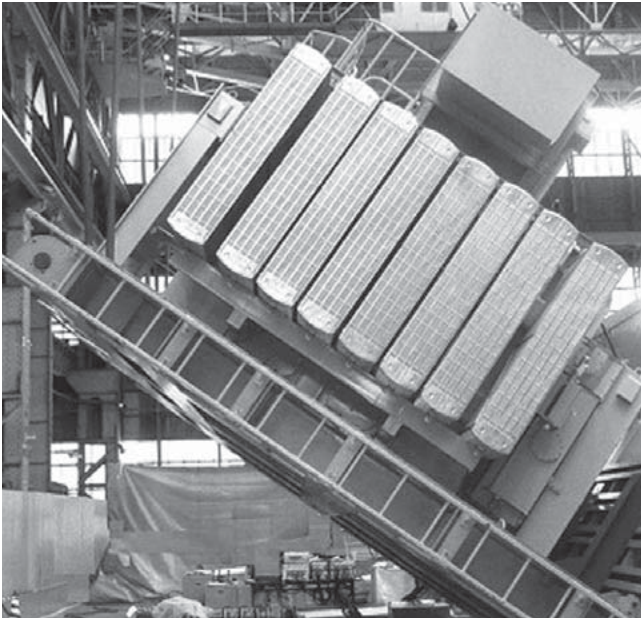
図10 | 変圧器傾き試験
