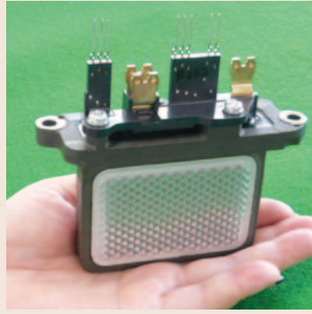
15 第3世代インバータ（左）、両面冷却型フルSiCパワーモジュール（中）、チップ並列接続構造（右）の外観
