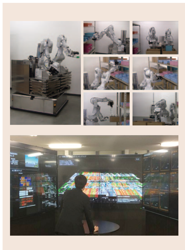
13 自律移動型双腕ロボットの動作（上）、コックピット技術（下）
