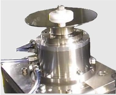
*Fig. 13—Spindle Motor.
