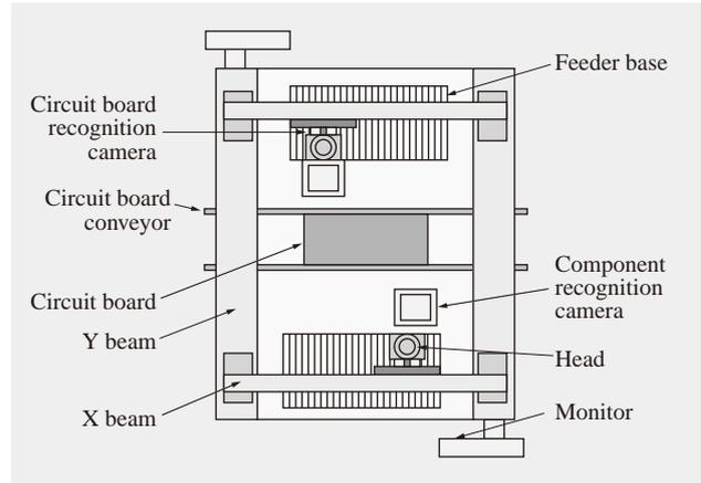
Fig. 7— $\Sigma$ -G5 Structure.
